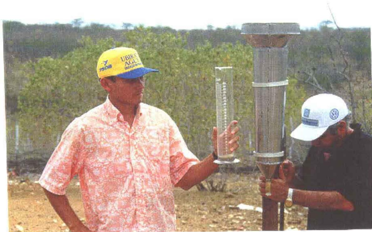
Figura 7: Proveta para determinação do total precipitado.
