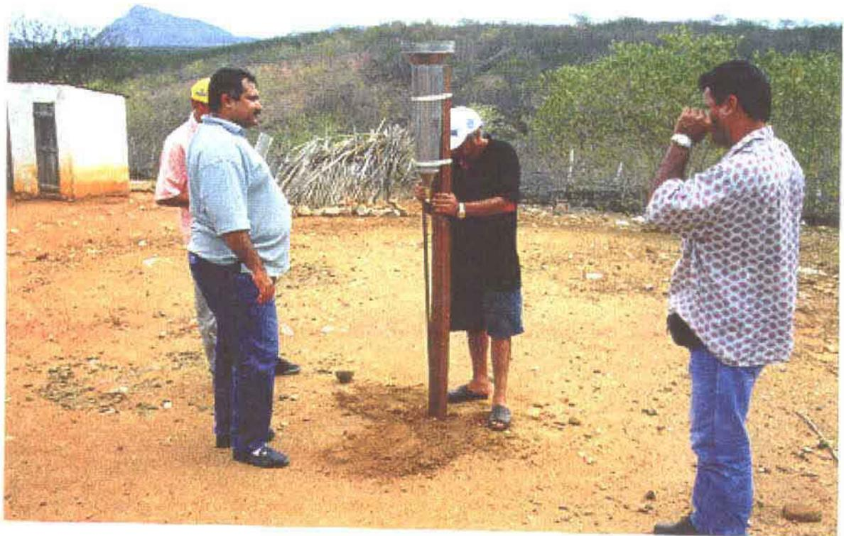
Figura 5: Instalação do Pluviômetro.
