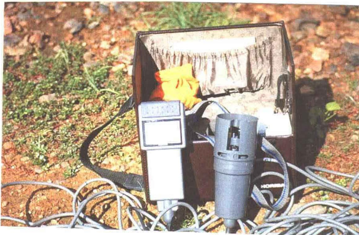
Figura 20: Aparelho Portátil para medir parâmetros de qualidade de água no campo.
