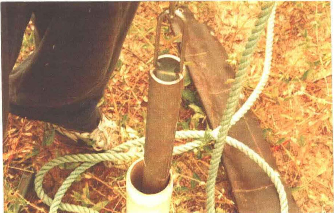
Figura 17: Detalhe do coletor de água dos poços.
