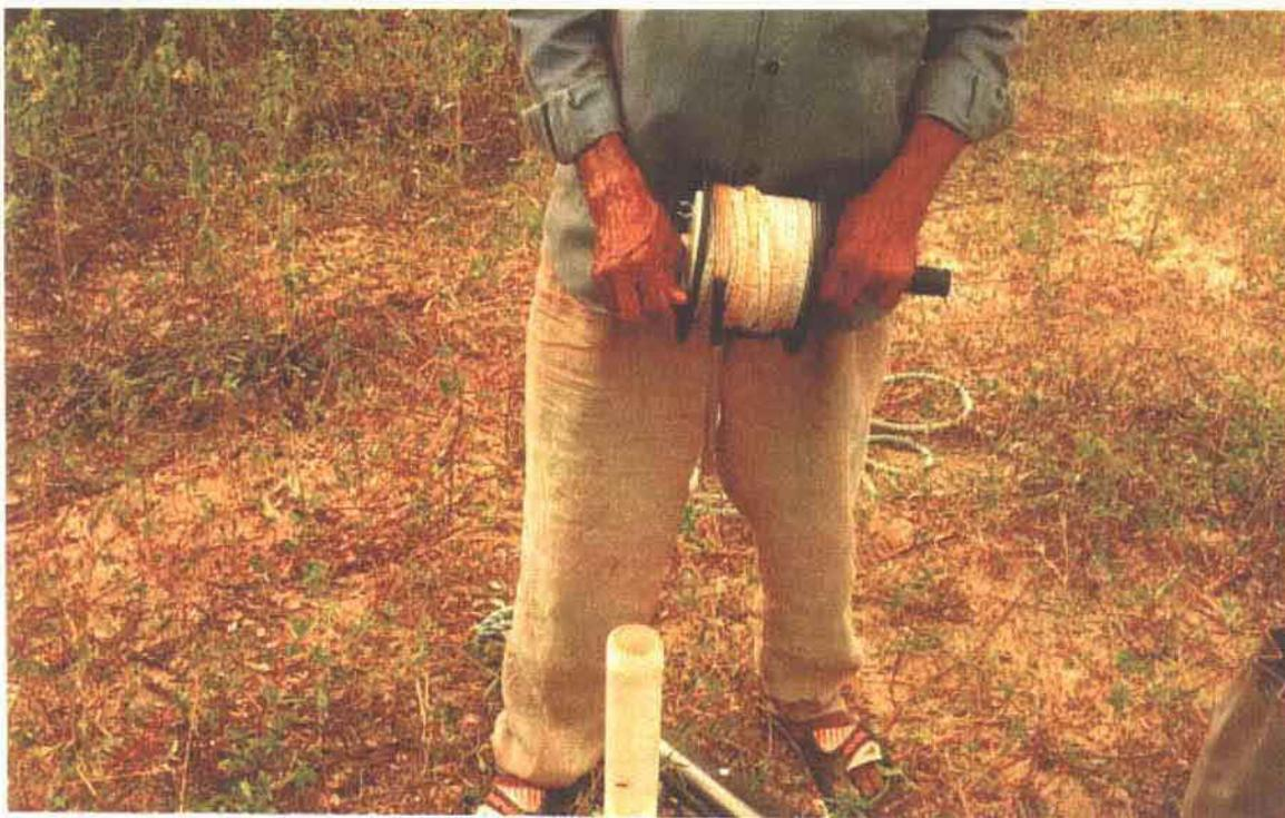
Figura 15: Determinação dos Níveis d'água nos poços de monitoramento a montante e a jusante das barragens através de sonda.
